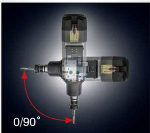
$\pm 90^\circ$  主軸可進行多角度旋轉加工，旋轉角度為正負 90 度。
