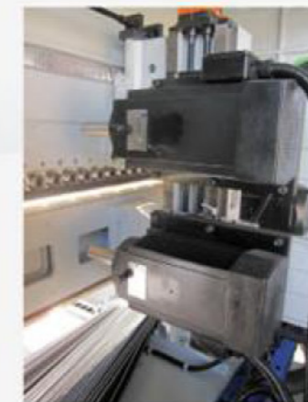
上下鉋 5HP(特殊要求7.5HP) 主轴转速:3600/7200 rpm (60/120HZ) 主轴尺寸:Ø40 x 120 mm
