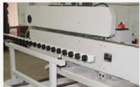
中央支撑架 适用于长板材以避免板材下垂或弯曲。
