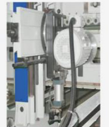
上下鉋 5HP(特殊要求7.5HP) 主轴转速:3600/7200 rpm (60/120HZ) 主轴尺寸:Ø40 x 120 mm
